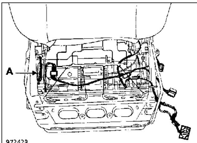
Снятие механизма регулировки сиденья по высоте (А) производится с помощью приспособления Car. 1253.
