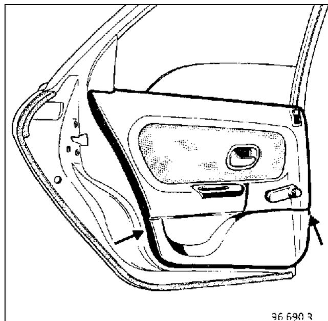
Отверните винты крепления обивки и отсоедините ее от фиксаторов.
