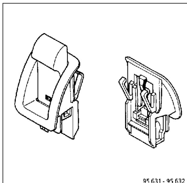
Снимите датчик сигнальной лампы закрытия двери.
