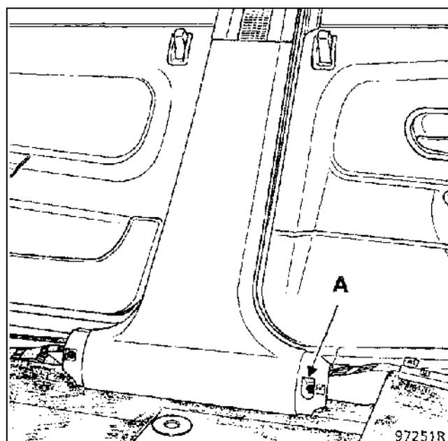
Отверните винт «торкс» на 20 (A).
