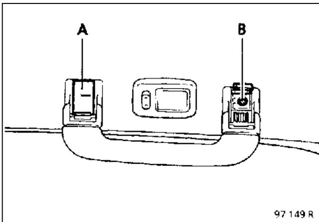
Снимите боковые поручни, открыв заглушки (А) и отвернув винты «торкс» на 20 (В).
