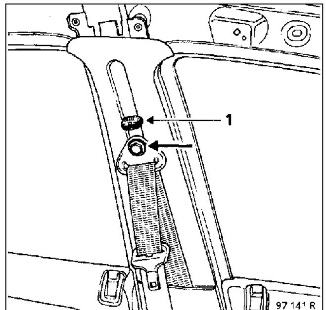
Отверните болты верхнего крепления ремней безопасности и снимите рычажок регулировки верхних креплений ремней по высоте (1).
