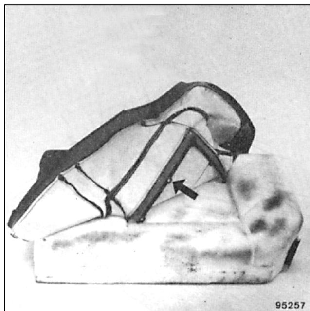
Откиньте обивку и срежьте фиксаторы с тупыми концами.
