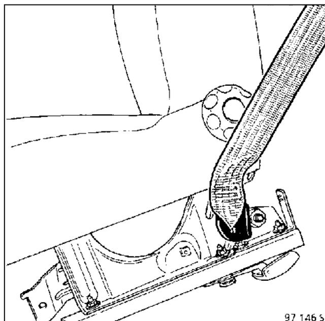
Приподнимите сиденье и отверните болт крепления ремня безопасности.
