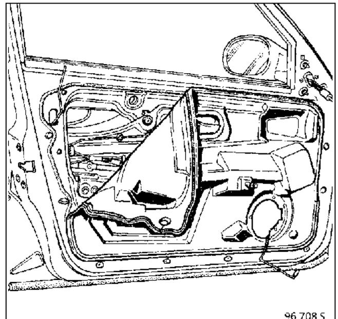
Во всех случаях при снятии – установке обивки двери строго обязательно заменять уплотнитель и влагозащитный виниловый фартук.
