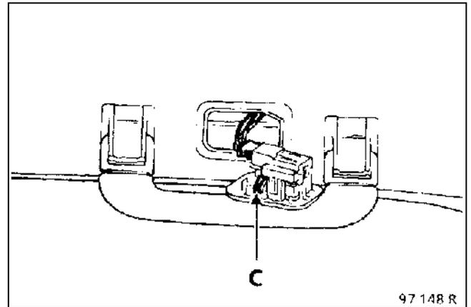
Снимите плафоны освещения салона, отсоединив металлические зажимы С.
