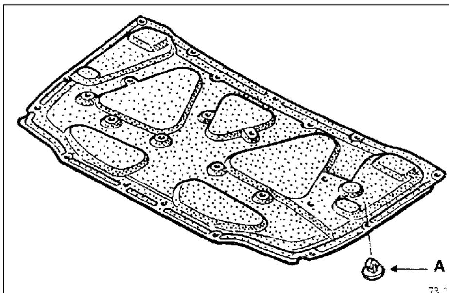
Отсоедините пластмассовые фиксаторы обивки (А).
