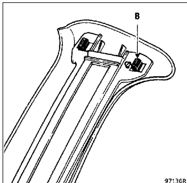
Отсоедините от фиксаторов верхнюю часть облицовки стойки (B) (на рисунке показан внутренний вид облицовки).
