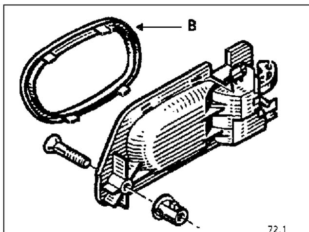
Осторожно отсоединяя обивку двери от фиксаторов, одновременно отсоедините декоративную рамку внутренней ручки двери (B).
