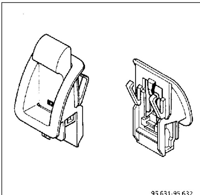
Снимите датчик сигнальной лампы закрытия двери.
