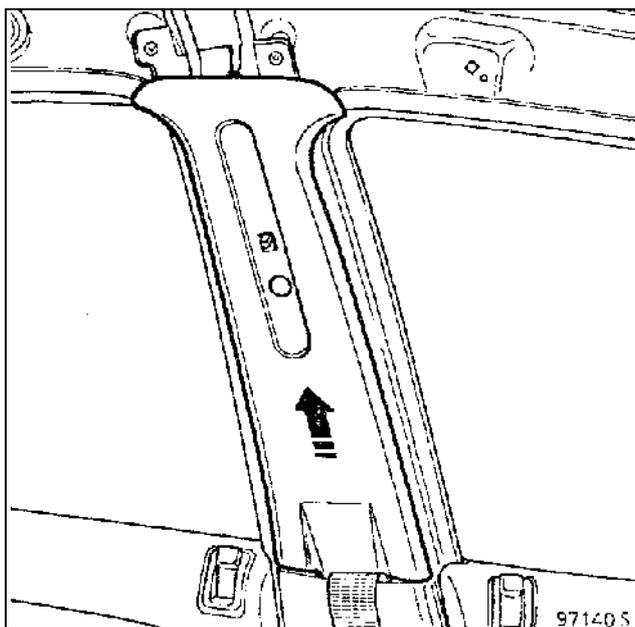
Снимите облицовку стойки, сдвинув ее вверх.
