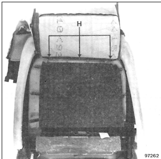
Еще выше поднимите обивку и срежьте три верхних фиксатора с тупыми концами (H).
