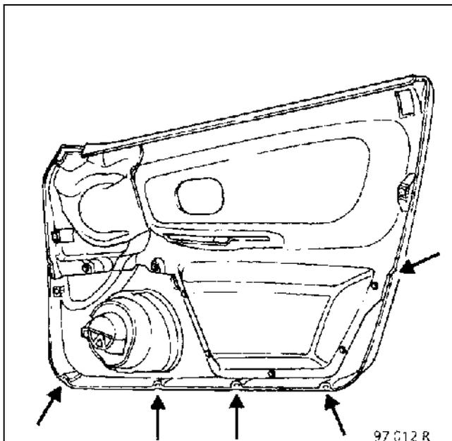
Отверните нижние винты крепления обивки двери («торкс» на 20).
