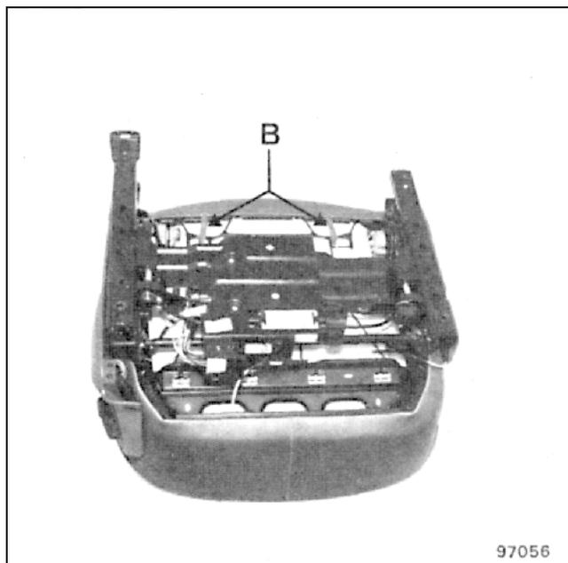
Срежьте фиксаторы с тупыми концами, крепящие две резинки под подушкой сиденья.
