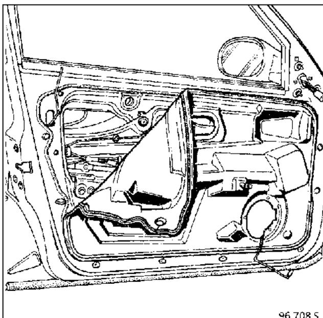
Во всех случаях при снятии – установке обивки двери строго обязательно заменять уплотнитель и влагозащитный виниловый фартук.
