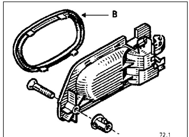
Осторожно отсоединяя обивку двери от фиксаторов, одновременно отсоедините декоративную рамку внутренней ручки двери.
