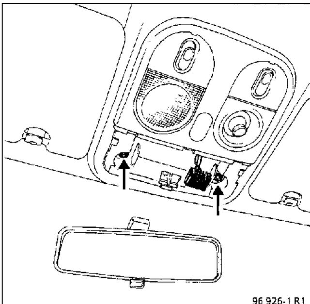
Снимите консоль потолка, отвернув два винта «торкс» на 20.
