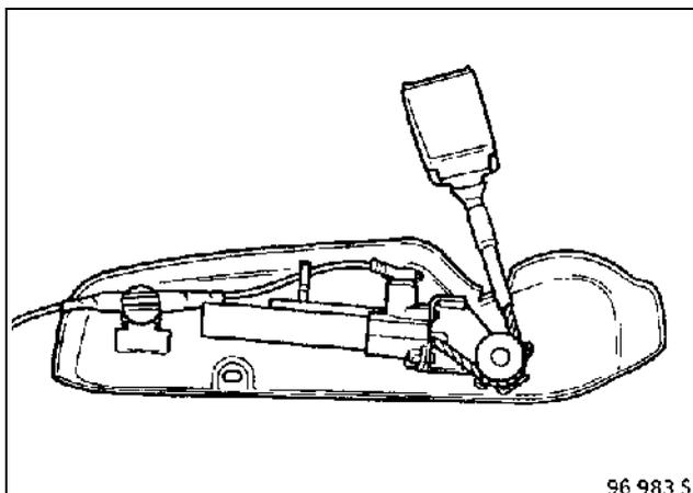
При снятии облицовок направляющих с системой преднатяжения ремней безопасности следует соблюдать меры предосторожности, указанные в документе «ПОДУШКА БЕЗОПАСНОСТИ» («AIR BAG»).
