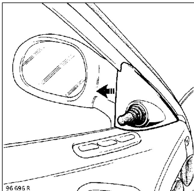
Отсоедините от фиксаторов облицовку крепления наружного зеркала заднего вида.
