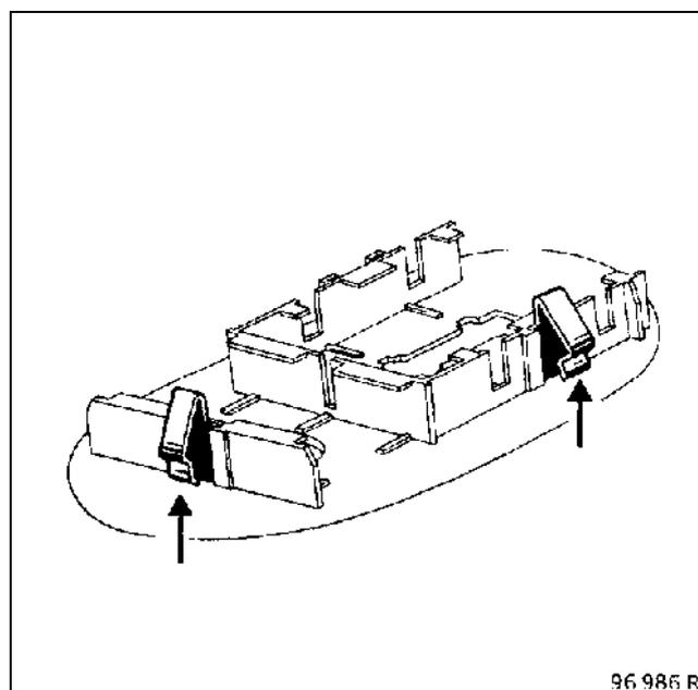
Снимите плату, отсоединив ее от фиксаторов.
