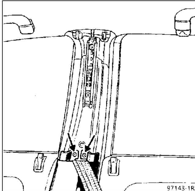
Отверните два верхних винта крепления «торкс» на 20 и снимите нижнюю облицовку стойки, отсоединив ее от фиксаторов.
