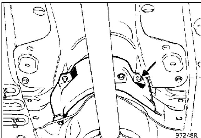
Действуя под автомобилем, отверните болты крепления сиденья, для чего:
