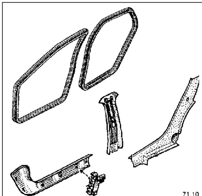
Частично снимите нижние части уплотнителей передней и задней дверей.
