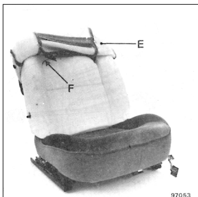
Поднять обивку еще выше и продеть остальные пластинки, действуя, как указано выше и следя за тем, чтобы не разорвать детали соединения пластинок с губчатой набивкой.
