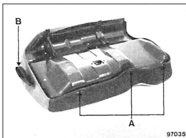
Отверните три винта «торкс» на 20 (А) и снимите рукоятку (В).
