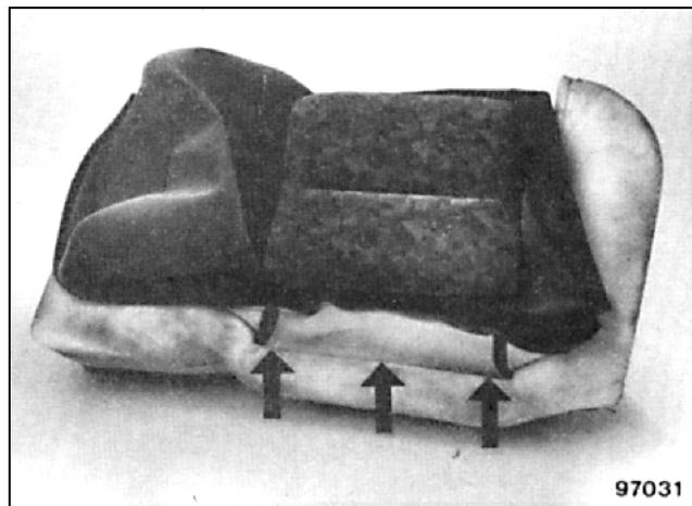
Срежьте фиксаторы с тупыми концами на задней стороне подушки сиденья.
