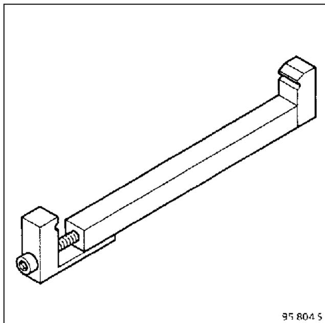
**Car. 1253** — приспособление для снятия и установки механизмов регулировки передних сидений по высоте.
