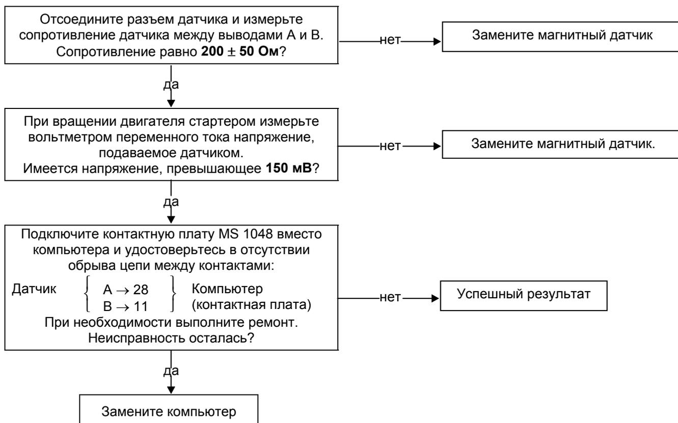
**Напоминание:** Конец правильно поляризованного датчика притягивается северным полюсом магнита (см. техническую ноту NT 1176).
