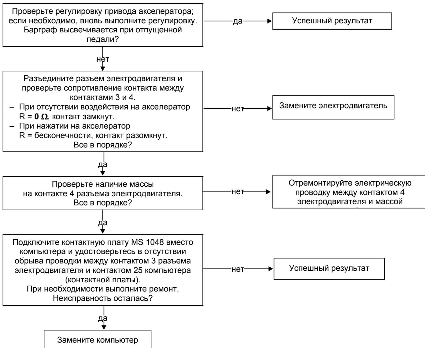
**Примечание:** Если электродвигатель новый, у него может быть полный возврат. В связи с этим нужно поместить клин ( $\cong 4$  мм) между толкателем и приводом акселератора, затем выключить зажигание.
