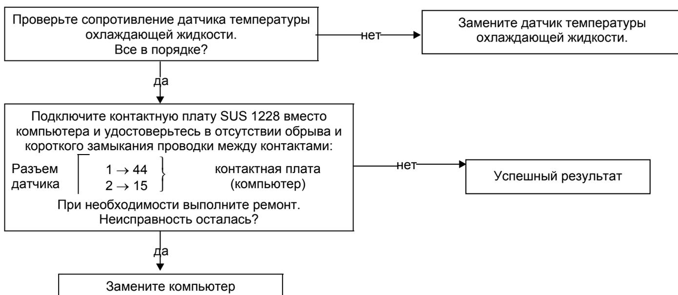
**Примечание:** Левый барграф 4 не высвечивается при коротком замыкании + датчика на контакт 44, но правый барграф 5 должен высвечиваться, при этом параметр, считываемый при выполнении проверки # 02, является переменной величиной.
