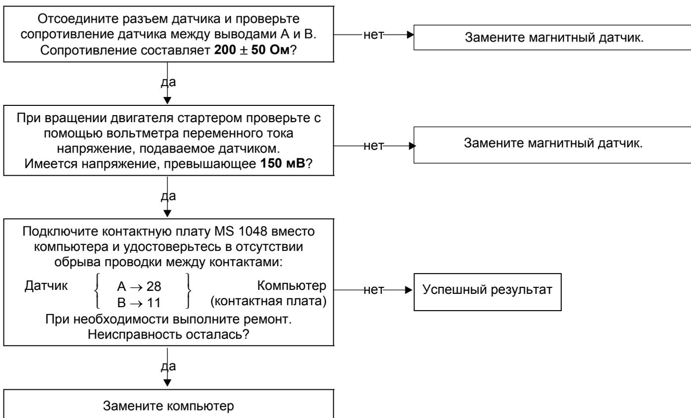
**Напоминание:** Конец правильно поляризованного датчика притягивается северным полюсом магнита (см. техническую ноту NT 1176).
