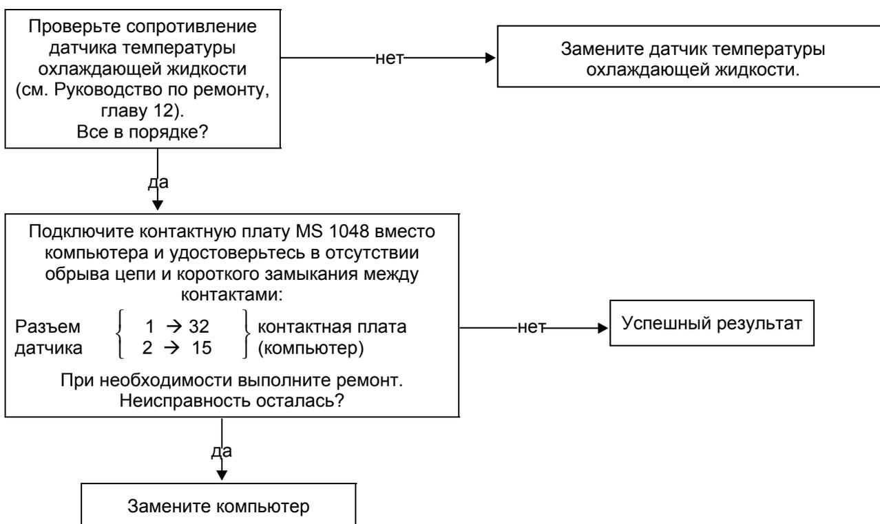
**Примечание:** Если при этом высвечивается также правый барграф 5, то имеет место обрыв цепи на участке между точкой А3 соединения проводов в жгуте двигателя и контактом 32 компьютера.
